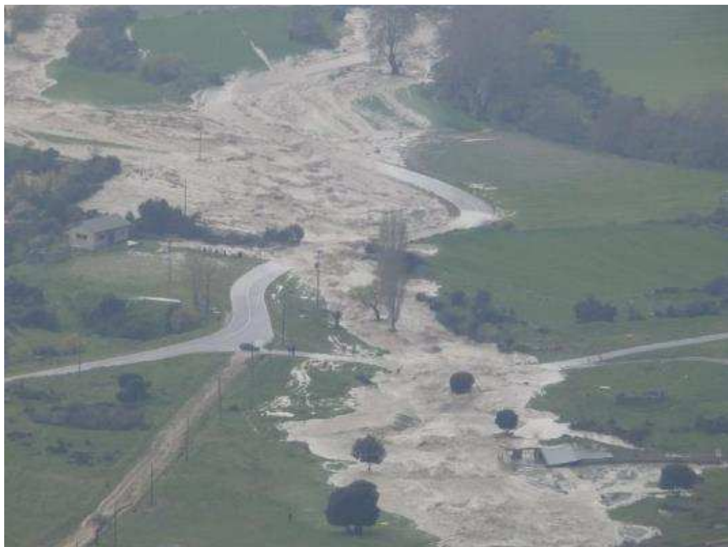
Φωτογραφία 6. Φράγμα Παλαιοχώρας Σπαρμού – Φωτογραφία πλημμυρικής παροχής αμέσως κατάντη του φράγματος, προς το τέλος της θραύσης (Φωτογραφία Κώστας Κουτσιούκης, 27/3/2016, 12:21)
